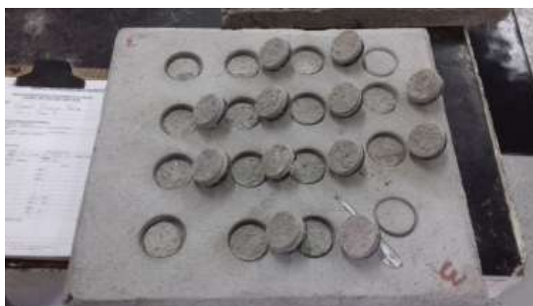
Figura 26 – Análise Visual dos Ensaios de Resistência à Aderência à Tração – Placa 3.
