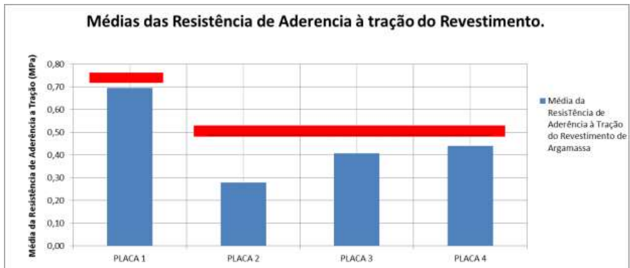
Figura 29 – Comparação das médias da resistência de aderência à tração do revestimento.
