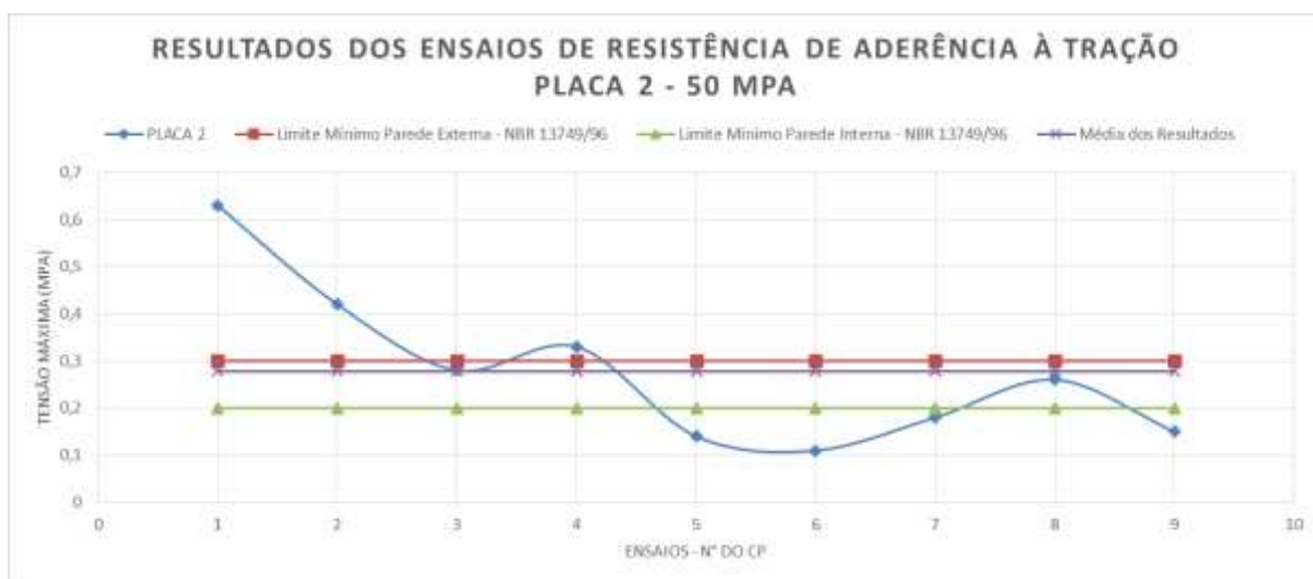
Figura 23 – Gráfico dos resultados dos Ensaios da Resistência de Aderência à Tração – Placa 2
