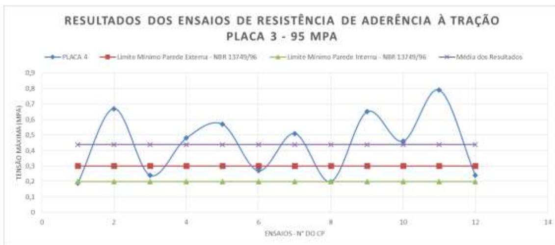
Figura 27 – Gráfico dos resultados dos ensaios de resistência de aderência à tração – Placa 4.
