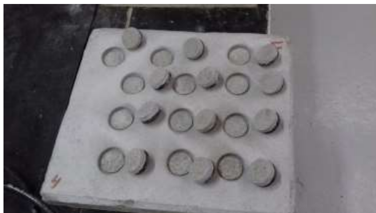
Figura 28 – Análise Visual dos Ensaio de Resistência à Aderência à Tração – Placa 4.
