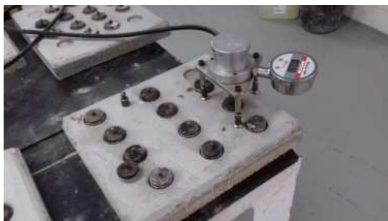
Figura 20 – Ensaio de Resistência de Aderência à tração.
