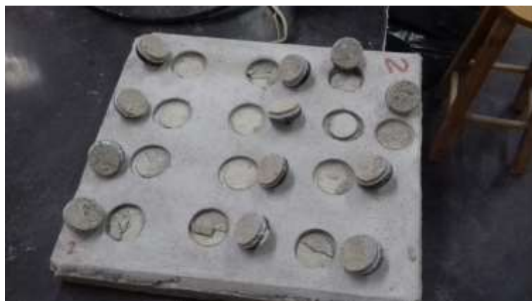
Figura 24 – Análise Visual dos Ensaios de Resistência à Aderência à Tração – Placa 2.
