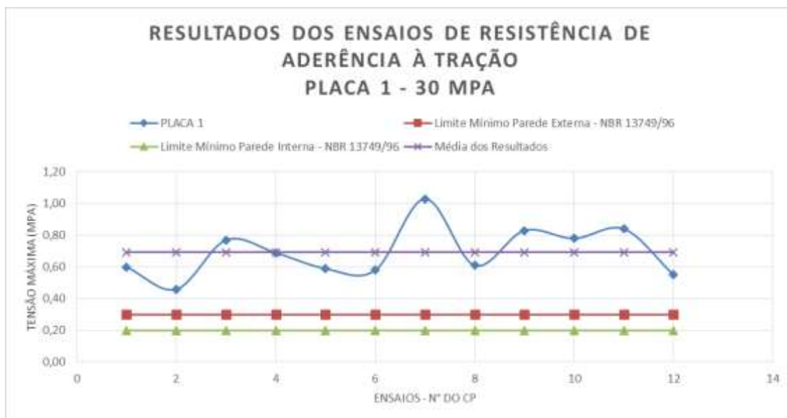
Figura 21 – Gráfico dos Resultados dos Ensaios de Resistência à Tração – Placa 1.
