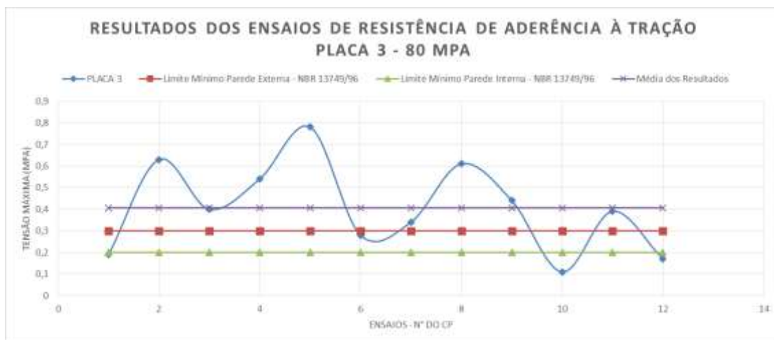
Figura 25 – Gráfico dos resultados dos ensaios de resistência de aderência à tração – Placa 3.
