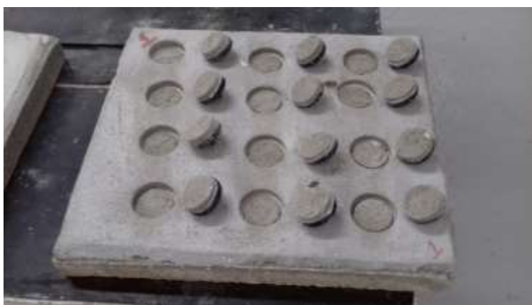
Figura 22 – Análise Visual dos Ensaios de Resistência à Aderência à Tração - Placa 1.
