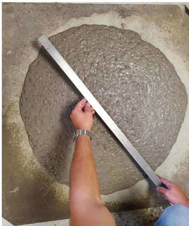
Figura 14– Espalhamento inicial do concreto com agregados na temperatura de 65^{\circ}\text{C} (exsudação)
