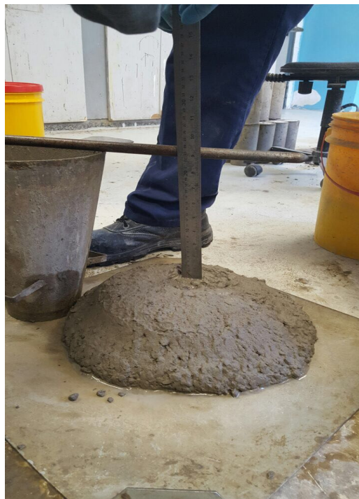
Figura 10 - Espalhamento inicial do concreto com agregados na temperatura de 105°C (evaporação)
