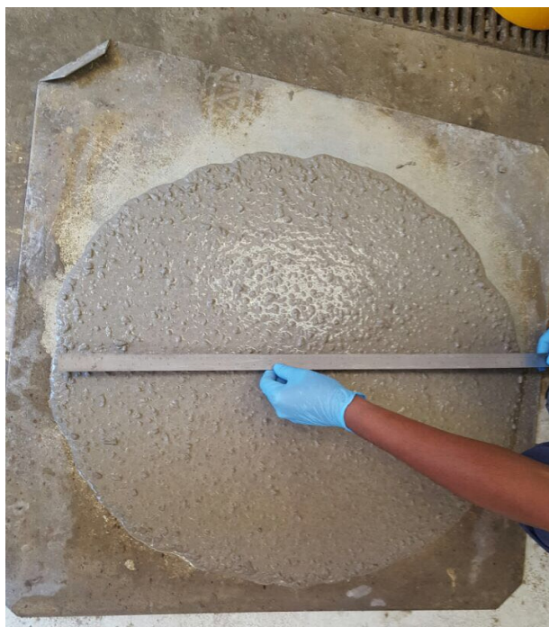
Figura 15– Espalhamento inicial do concreto com agregados na temperatura de 45°C (exsudação)
