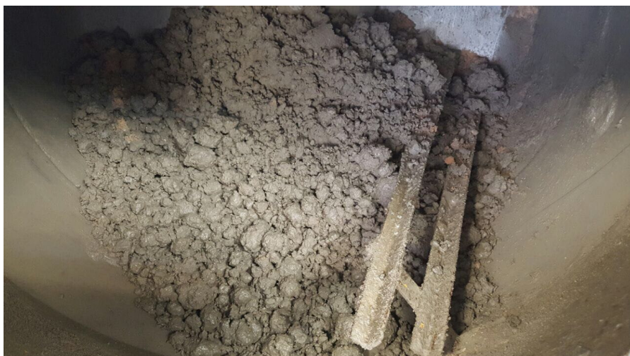
Figura 12– Mistura do concreto com agregados na temperatura de 105°C antes da adição do aditivo (evaporação)
