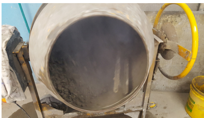
Figura 11 - Mistura do concreto com agregados na temperatura de 105°C (evaporação)
