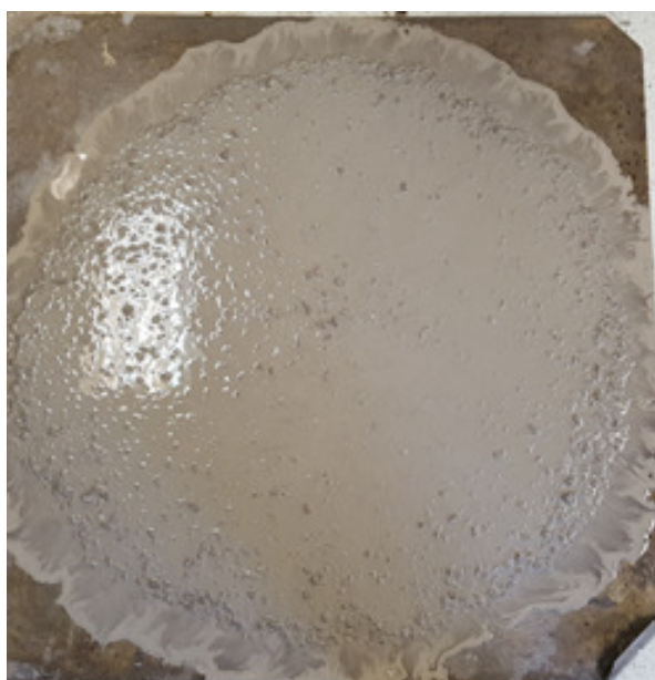
Figura 13 – Espalhamento inicial do concreto com agregados na temperatura de 5°C (exsudação)
