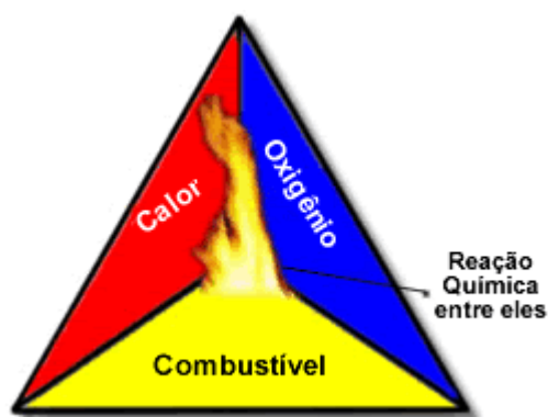
Figura 4 - Triângulo do fogo (Fonte: http://www.cursor10.com/teoria-do-fogo )
