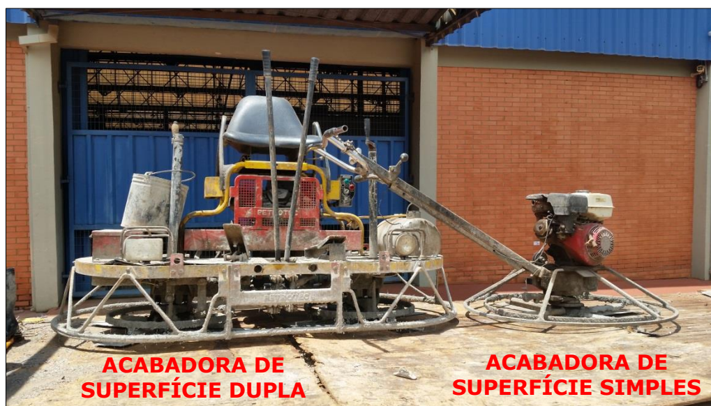
Figura 31. Acabadoras de superfície dupla e simples (ROMERO, 2016).
