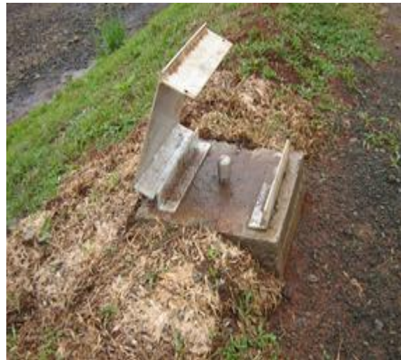
Figura 19 - MSS - Marco Superficial para instalação em Solo. Fonte (Commetro, 2021)
