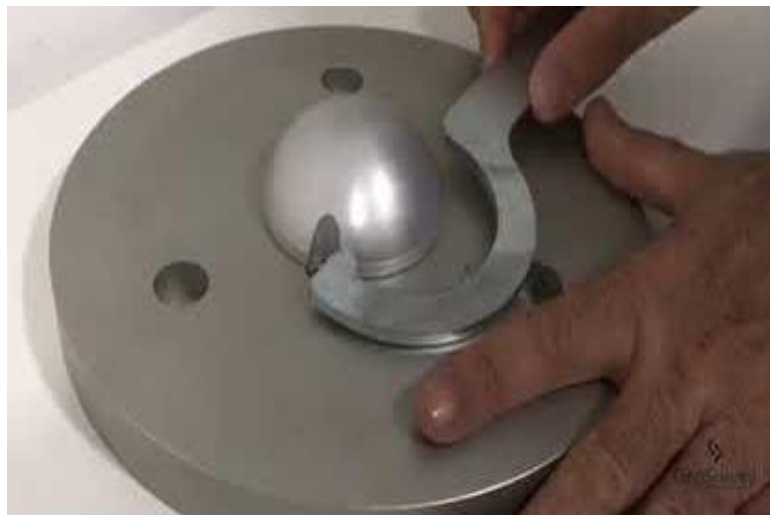
Figura 15 - Benchmark modelo de centragem forçada, com proteção do parafuso
