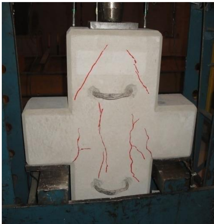
Figura 20-c. Panorama de fissuração do modelo M03-C9. Fonte: o autor, 2016.
