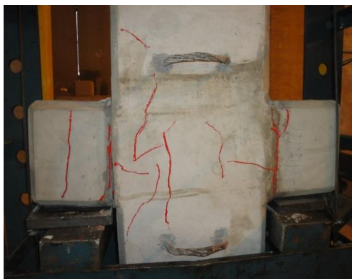
Figura 19-b. Panorama de fissuração do modelo M02-C5.
