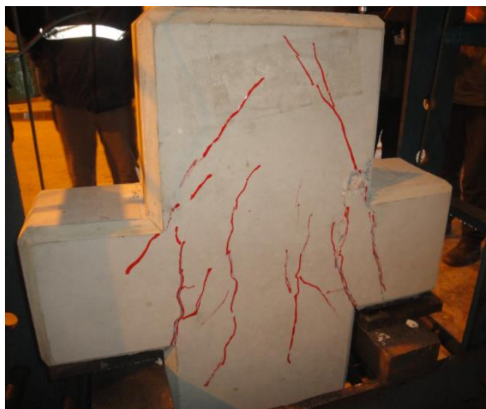
Figura 21-b Panorama de fissuração do modelo M04-C11.
