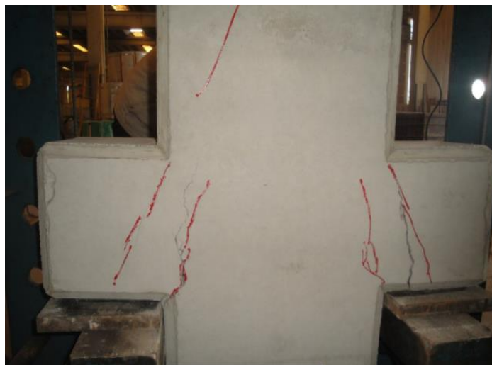
Figura 23–b. Panorama de fissuração do modelo M06-C17.
