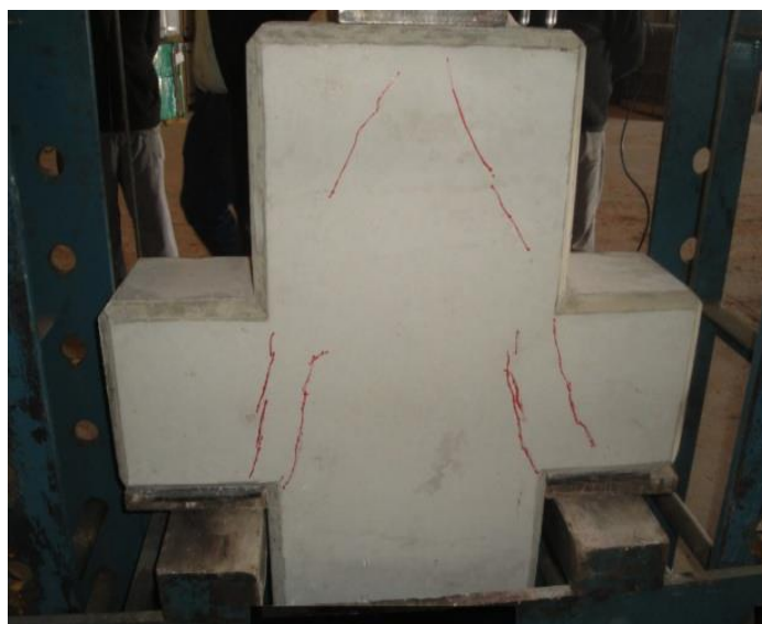
Figura 23–a. Panorama de fissuração do modelo M06-C16.
