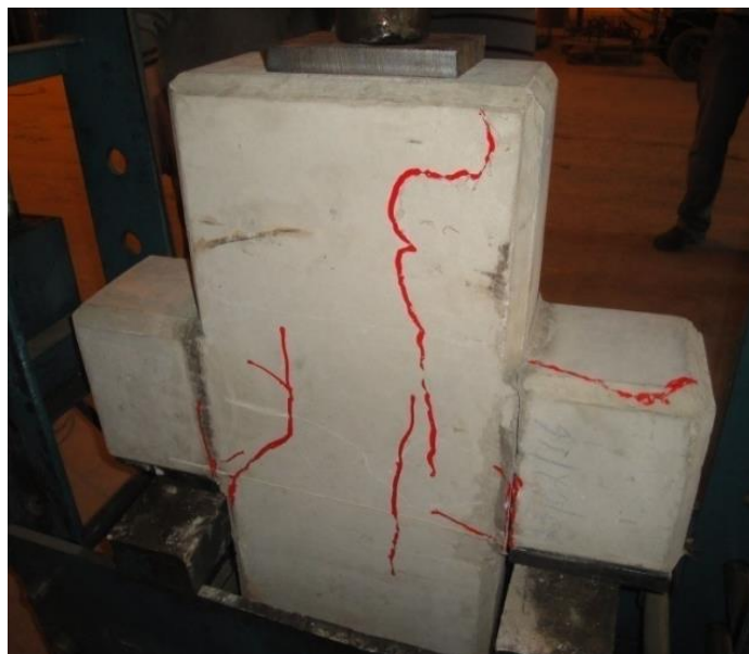
Figura 19-a. Panorama de fissuração do modelo M02-C4.
