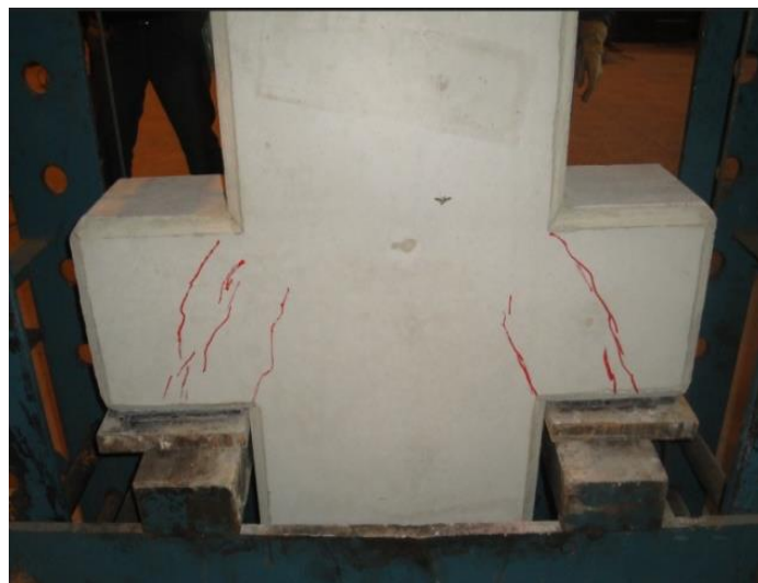
Figura 22-b. Panorama de fissuração do modelo M05-C14.
