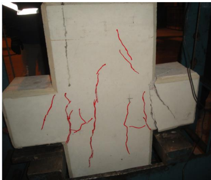
Figura 21-a. Panorama de fissuração do modelo M04-C10.
