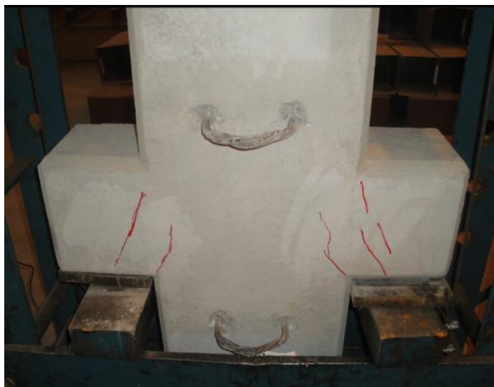
Figura 22-c. Panorama de fissuração do modelo M05-C15. Fonte: o autor, 2016.
