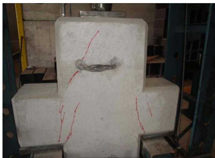
Figura 23–c. Panorama de fissuração do modelo M06-C18. Fonte: o autor, 2016.
