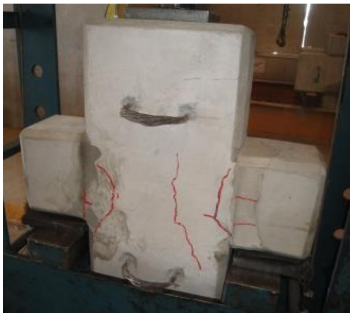
Figura 18-a. Panorama de fissuração do modelo M01-C1.
