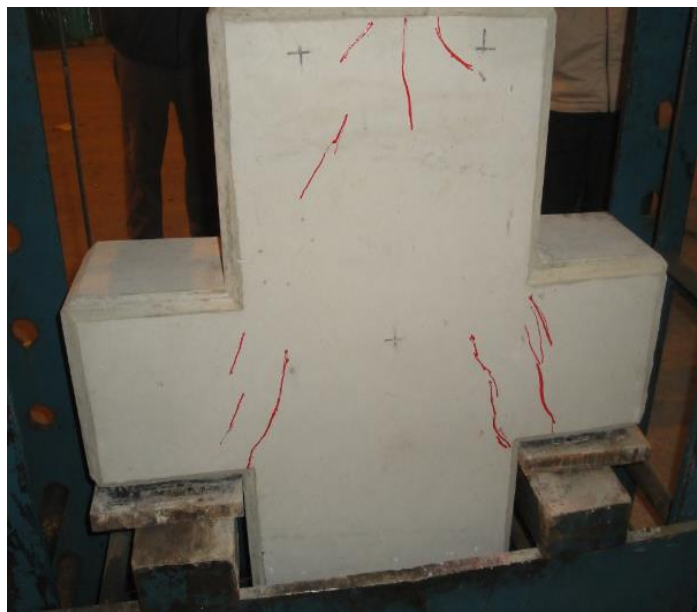
Figura 22-a. Panorama de fissuração do modelo M05-C13.
