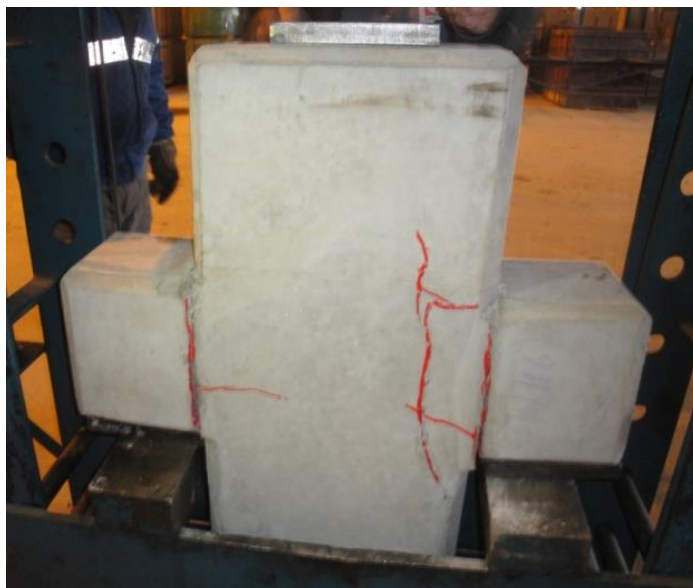
Figura 19-c. Panorama de fissuração do modelo M02-C6. Fonte: o autor, 2016.
