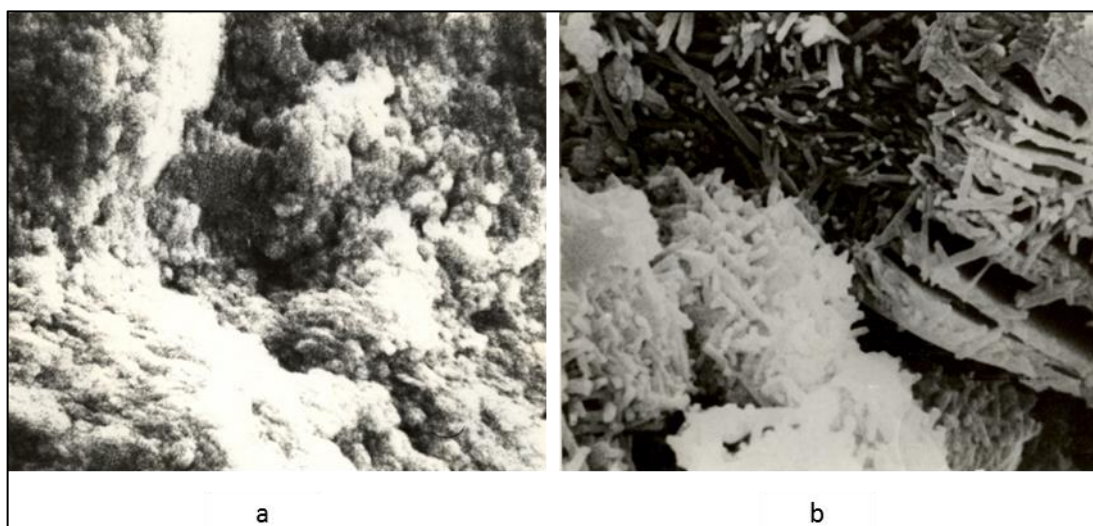
Figura 5 - Microfábrica de um solo laterítico (a) e saprolítico (b), com aumento de 10.000X (Villibor, 1981)
