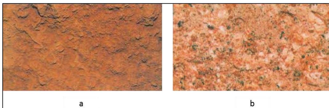
Figura 4 - Exemplo de macrofábrica de solos tropicais: a) homogênea com agregação, latossolo vermelho-amarelo (laterítico); b) manchada, isotópica, contínua (solo saprolítico de granito (Nogami e Villibor, 1995))
