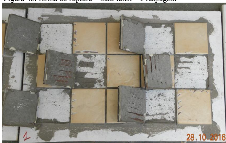
Figura 40: forma de ruptura – base latex – 1 raspagem
