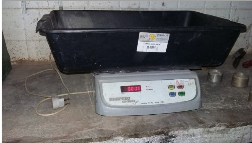
Figura 18: Ajuste da balança, com o desconto do peso da caixa para massa
