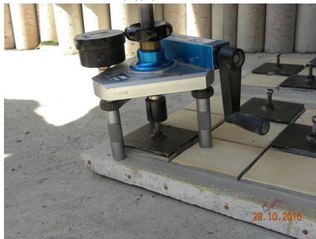
Figura 28: dinamômetro acoplado a pastilha metálica para realização do ensaio
