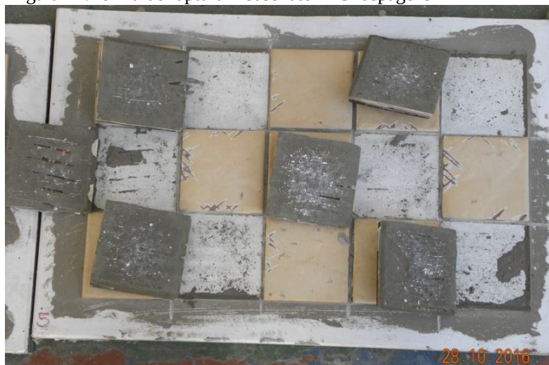
Figura 42: forma de ruptura – base latex – 5 raspagens
