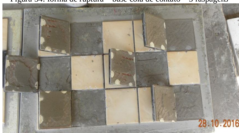
Figura 34: forma de ruptura – base cola de contato – 5 raspagens
