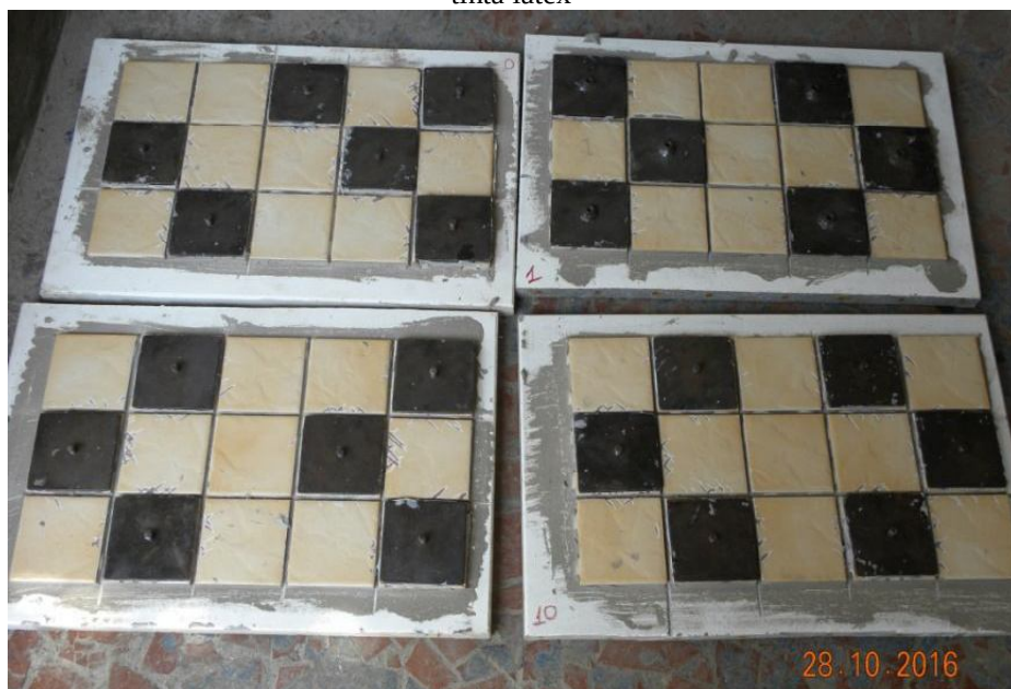
Figura 26: pastilhas metálicas coladas com massa plástica no revestimento cerâmico – base tinta latex
