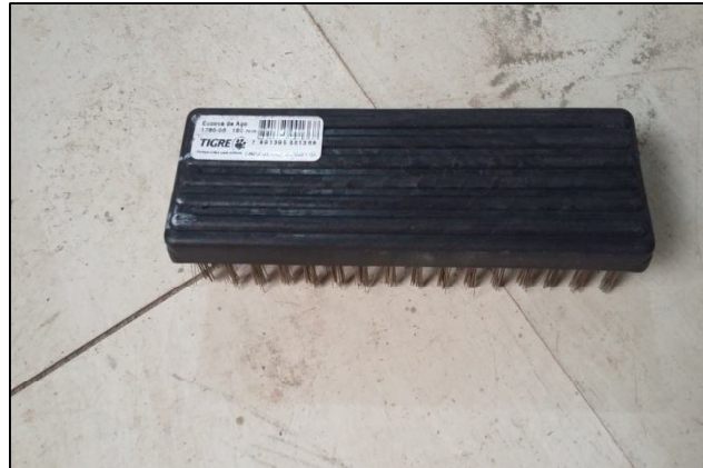
Figura 13: Escova de aço utilizada para raspagem
