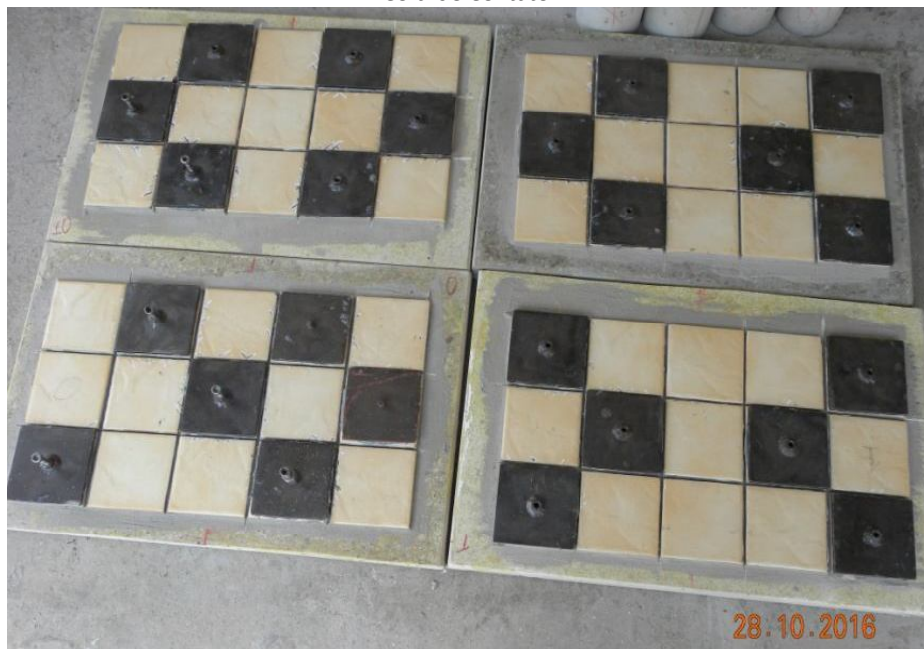
Figura 25: pastilhas metálicas coladas com massa plástica no revestimento cerâmico – base cola de contato
