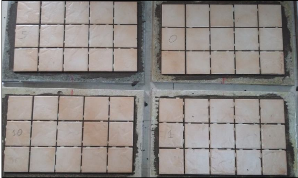
Figura 24: Revestimento cerâmico aplicado sobre superfície com cola de contato
