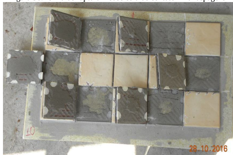
Figura 36: forma de ruptura – base cola de contato – 10 raspagens
