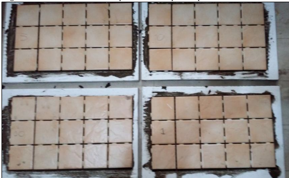
Figura 23: Revestimento cerâmico aplicado sobre superfície pintada
