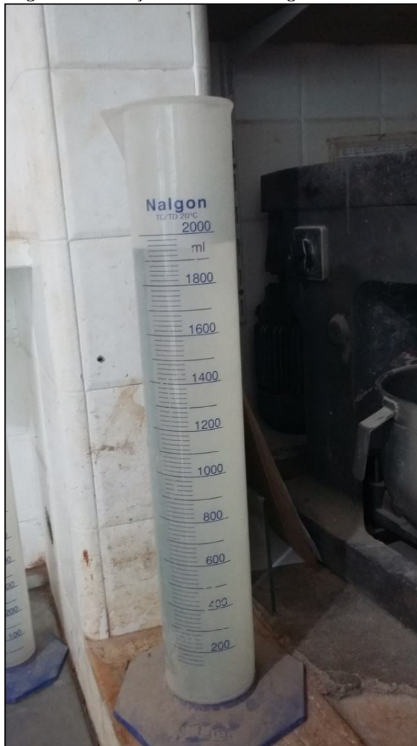
Figura 20: Medição do volume de água de amassamento da argamassa
