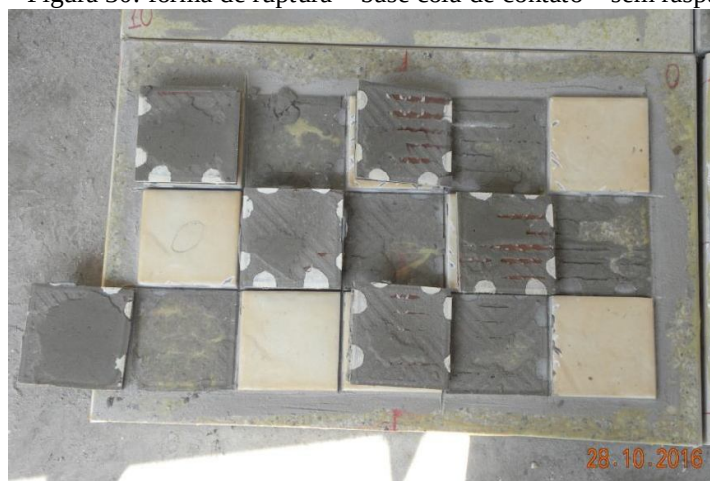
Figura 30: forma de ruptura – base cola de contato – sem raspagem
