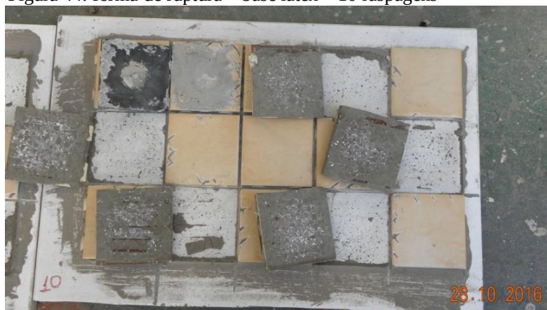
Figura 44: forma de ruptura – base latex – 10 raspagens
