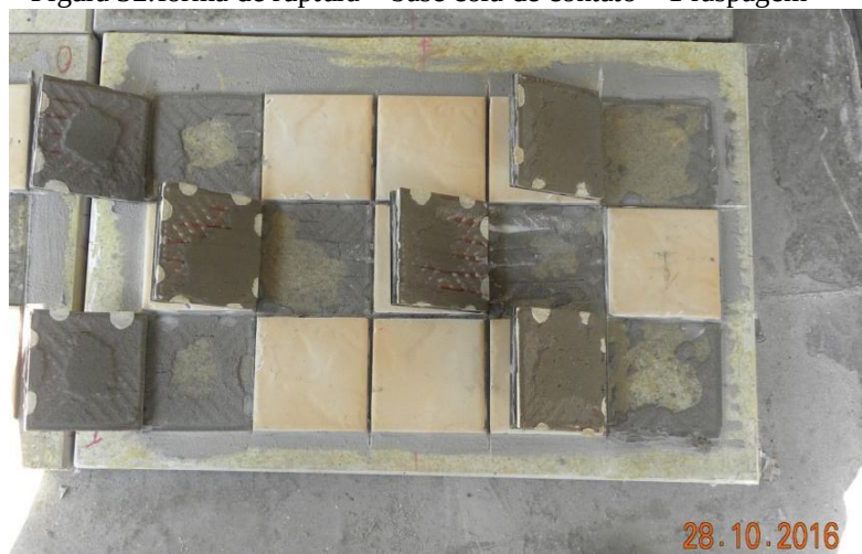
Figura 32: forma de ruptura – base cola de contato – 1 raspagem
