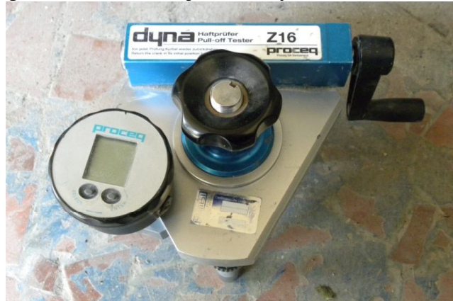
Figura 27: dinamômetro para realização do ensaio de aderência a tração
