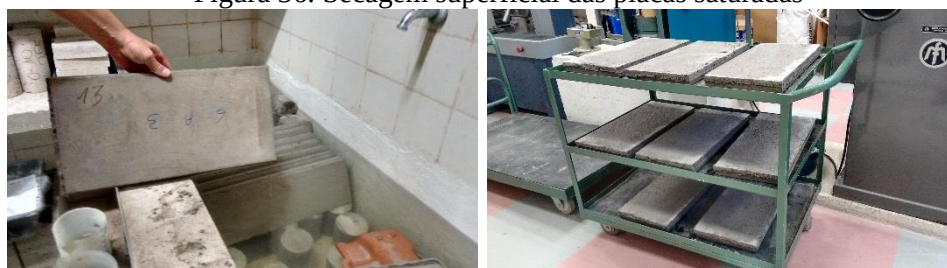
Figura 36: Secagem superficial das placas saturadas
