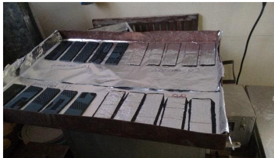
Figura 19: Amostras em ensaio de envelhecimento – conforme ABNT NBR 9952 (2014)
