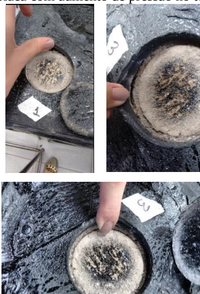
Figura 68: Teste de aderência da placa com aumento de pressão no teste de estanqueidade
