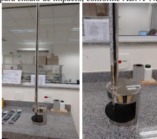
Figura 15: Dispositivo para ensaio de impacto, conforme ABNT NBR 9952 (2014)
