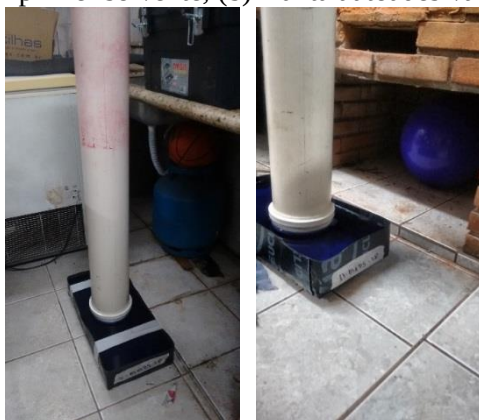
Figura 49 Placas em teste de estanqueidade com aumento de pressão na emenda: (a) Manta aderida à maçarico com primer solvente; (b) manta autoadesiva com primer solvente
