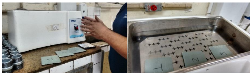
Figura 13: Ensaio de absorção – conforme ABNT NBR 9952 (2014)
