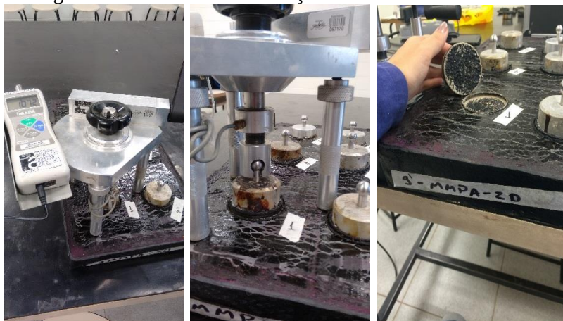
Figura 53: Ensaio de determinação de resistência à aderência
