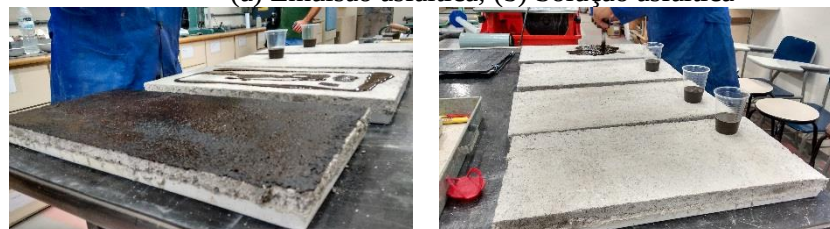
Figura 25: Primers: (a) Emulsão asfáltica; (b) Solução asfáltica
