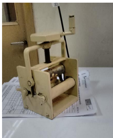
Figura 14: Mandril para ensaio de flexibilidade – conforme ABNT NBR 9952 (2014)
