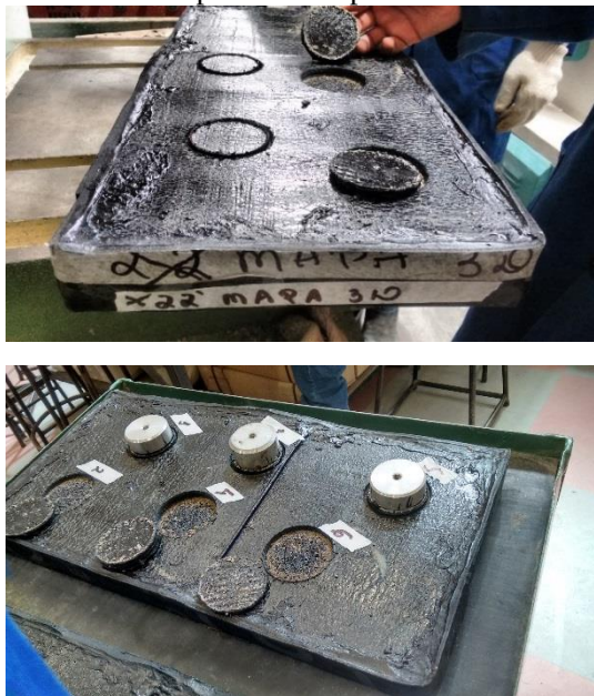
Figura 72: Rompimento durante o corte de placas com permeabilidade de água sob manta
