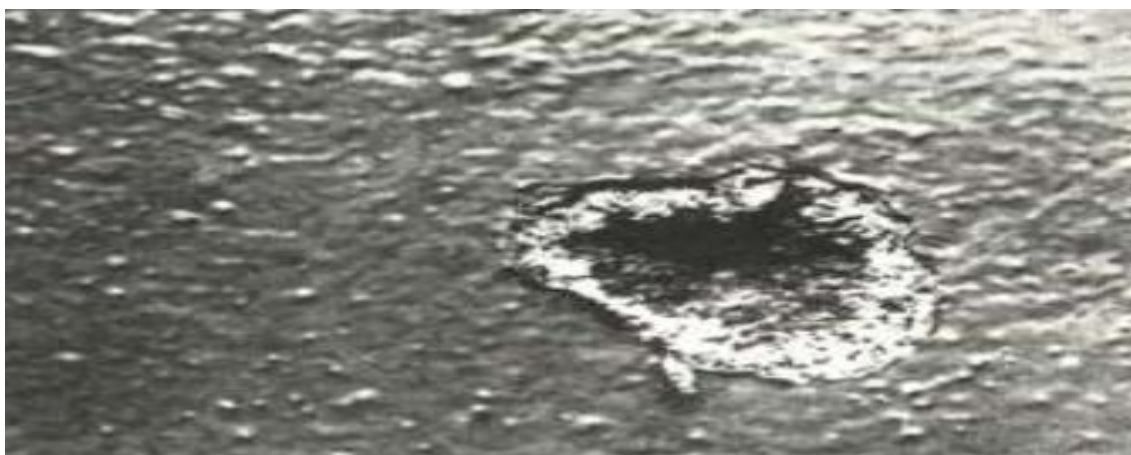
Figura 9. Vesícula no revestimento (THOMAZ, 1989).
