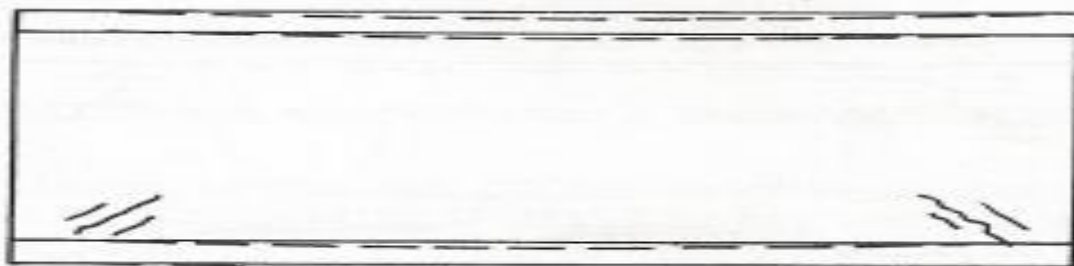
Figura 19. Deformação do suporte e viga superior igual (FERREIRA, 2012)
