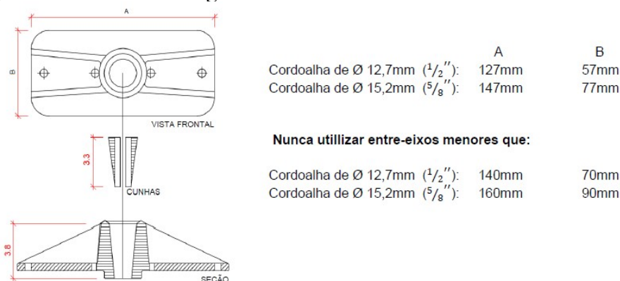
Figura 4: Dimensões e espaçamentos mínimos entre as ancoragens (SOUZA, 2017)
