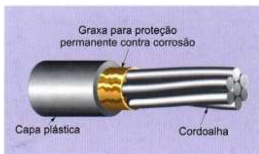
Figura 1: Detalhe da Cordoalha engraxada. (ARCELLOR MITTAL, 2017)
