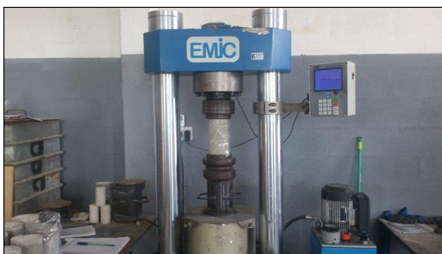
Figura 20 - Ensaio de Compressão Axial (OS AUTORES, 2017)
