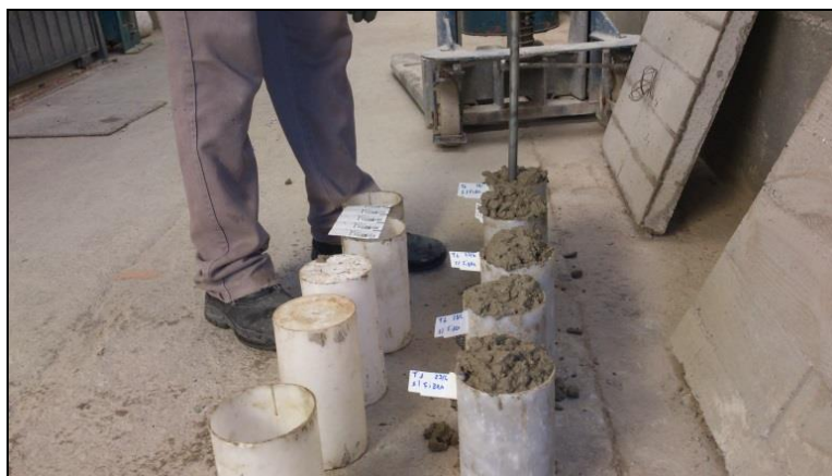
Figura 16 - Moldagem dos Corpos de Prova (OS AUTORES, 2017)
