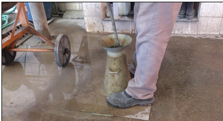
Figura 15 - Slump Test (OS AUTORES, 2017)
