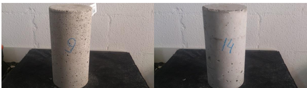
Figura 24 – Porosidade do Concreto (OS AUTORES, 2017)
