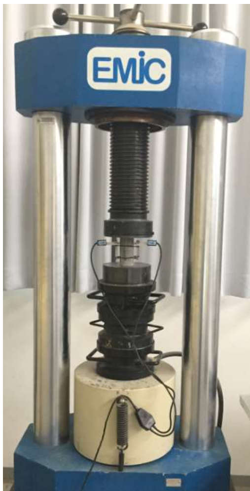
Figura 29 Ensaio do módulo de deformação da pasta de cimento CP II Z – 32 utilizado no concreto (ACERVO DO AUTOR, 2017)
