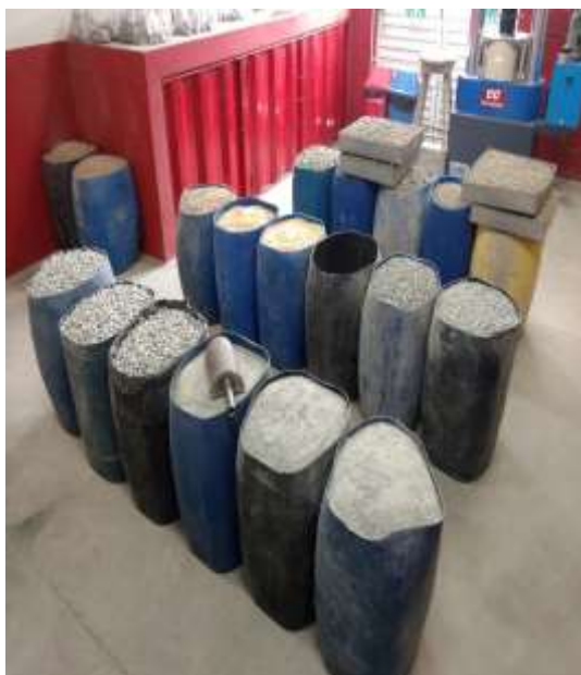
Figura 18. Agregados secos para produção de concreto (ACERVO DO AUTOR, 2017)
