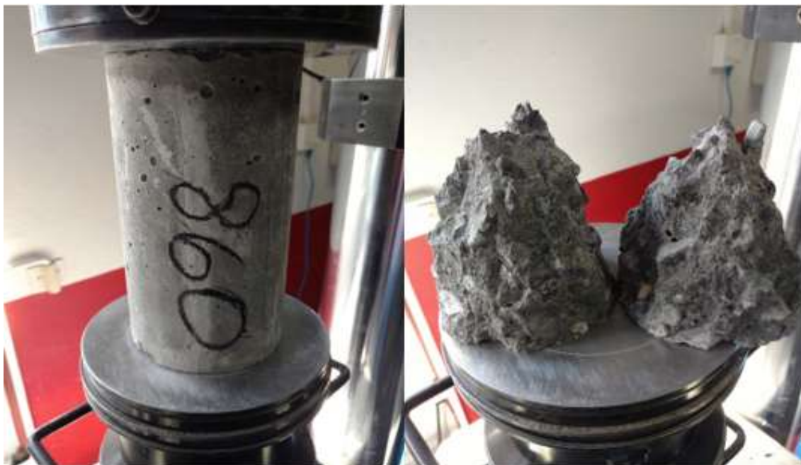
Figura 24 Ensaio de resistência à compressão cilíndrica de 10x20 cm (ACERVO DO AUTOR, 2017)
