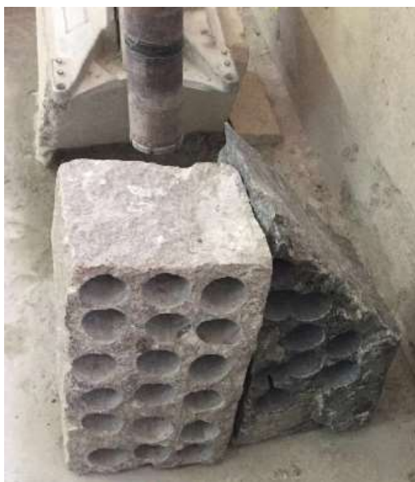
Figura 11. Bloco de rocha onde foram extraídos os corpos de prova para ensaio de módulo de deformação, a esquerda granito e a direita gnaiss (ACERVO DO AUTOR, 2017)
