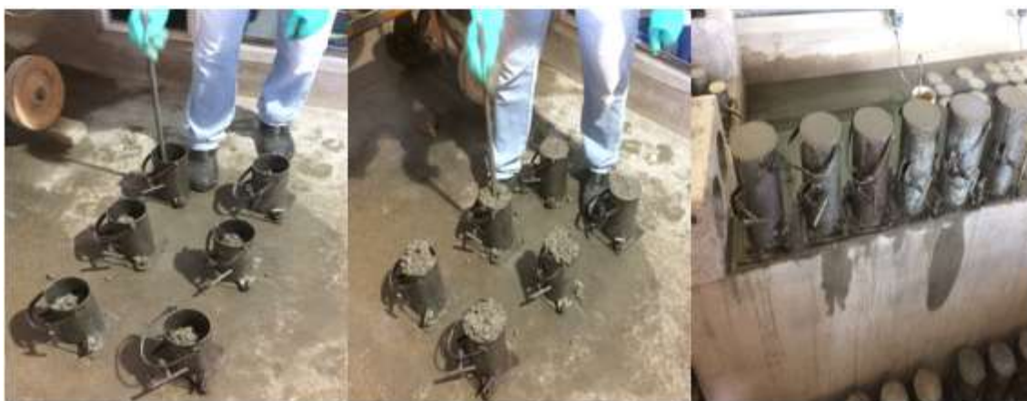
Figura 22. Moldagem dos corpos de prova (ACERVO DO AUTOR, 2017)
