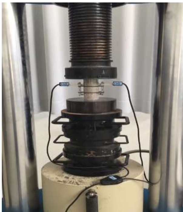
Figura 13. Ensaio de módulo de deformação da rocha (ACERVO DO AUTOR, 2017)
