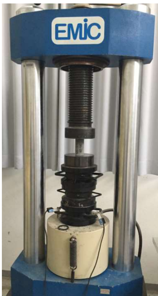
Figura 28. Ensaio de resistência compressão da pasta de cimento CP II Z – 32 utilizado no concreto (ACERVO DO AUTOR, 2017)
