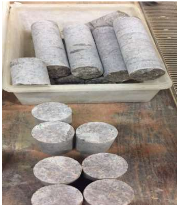
Figura 12. Corpos de prova para ensaio de módulo de deformação (ACERVO DO AUTOR, 2017)
