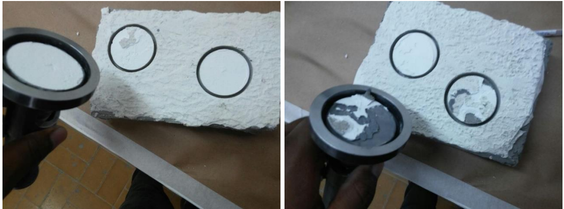
Figure 26 - Local de rompimento nos Cps
