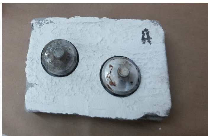
Figure 22 - Corpo de prova cortado já com as pastilhas fixadas
