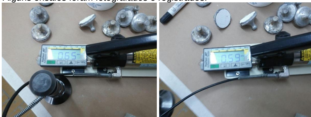
Figure 23 - Resultado 0,65Mpa (Emboço + textura) e resultado 0,80Mpa (Emboço+selador+textura)
