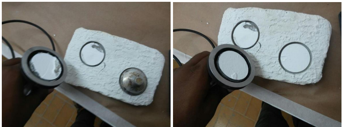
Figure 27 - Local de rompimento nos Cps
