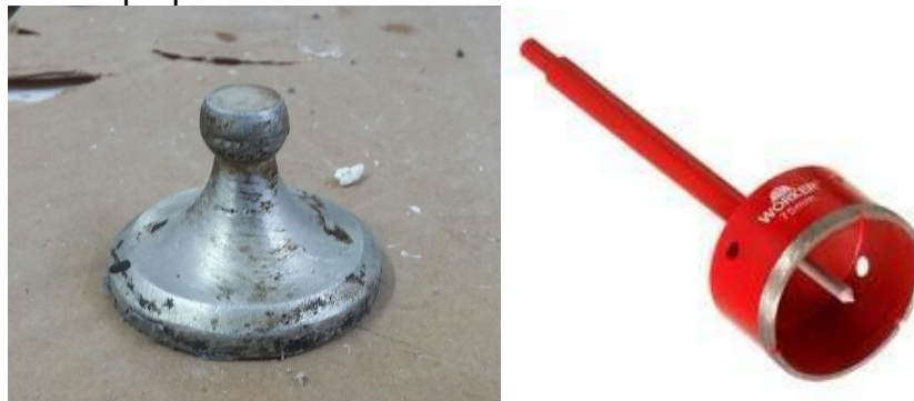
Figure 20 - Pastilha metálica (NBR 13528:2010) e serra copo.
