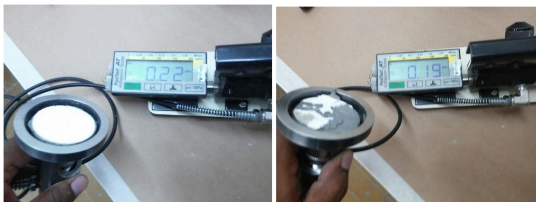
Figure 24 - Resultado 0,22Mpa(Emboço+massa corrida+selador+textura) e resultado 0,19Mpa (Emboço+massa corrida+textura)
