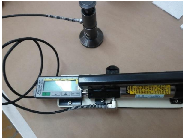
Figure 18 - Dinamômetro de tração (NBR 13528:2010). Fonte: Autores.
