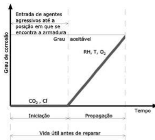
Gráfico 5 - Modelo de Tuutti para a corrosão de armaduras
