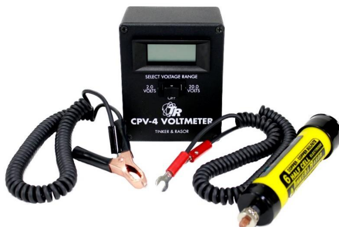
Figura 11. Equipamentos para ensaio de potencial de corrosão (TINKER & RASOR, 2017)
