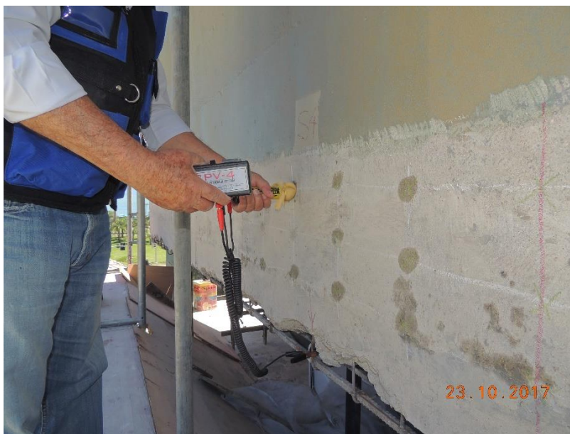
Figura 31. Execução do Ensaio de Potencial de Corrosão (AUTORES, 2017)
