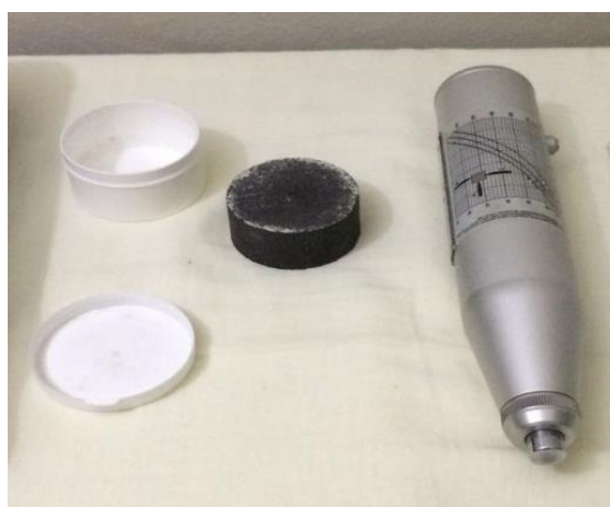
Figura 26. Equipamento utilizado para o Ensaio de Esclerometria (AUTORES, 2017)
