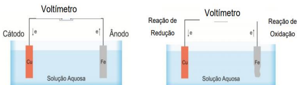
Figura 3. Modelo da célula de corrosão galvânica (CARVALHO, 2014)
