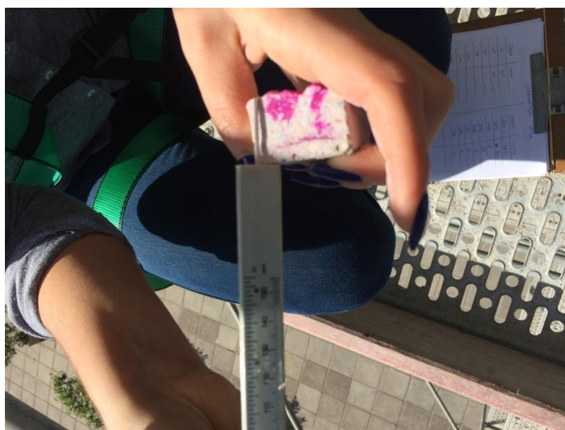
Figura 25. Ensaio de Carbonatação (AUTORES, 2017)
