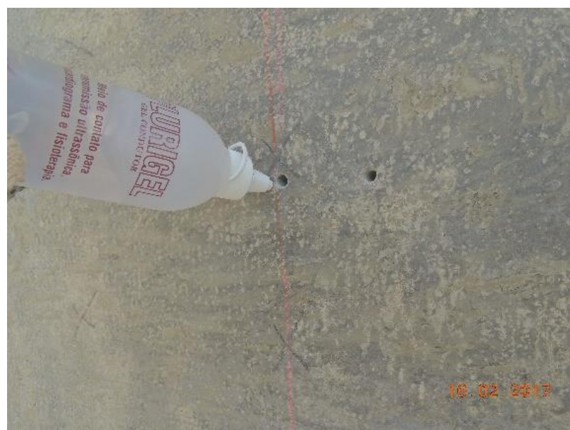
Figura 33. Aplicação de gel nos furos para execução do Ensaio de Resistividade Elétrica do Concreto (AUTORES, 2017)
