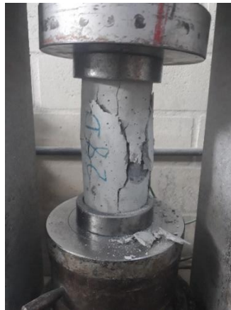
Figura 78 - Ensaio de resistência à compressão com utilização de almofadas elastoméricas em fôrmas confinadas
