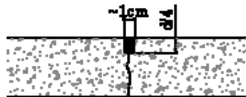
Figura 12 – Junta serrada de contração Fonte: Balbo (1999)
