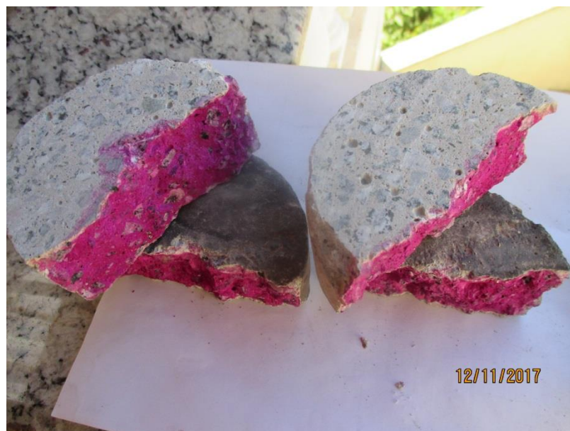
Figura 43 – Vista externa comparativa entre corpo de prova impregnado por fuligem (esquerda) e não impregnado por fuligem (direita)
