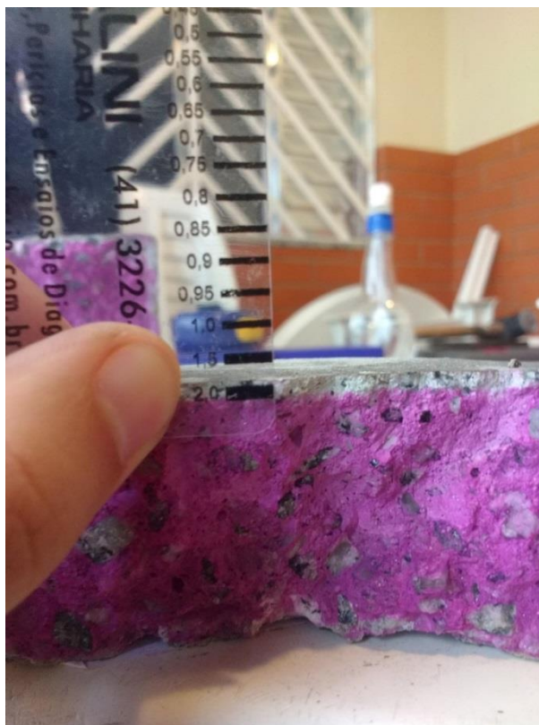
Figura 21 – Confirmação da leitura feita via paquímetro com o fissurômetro
