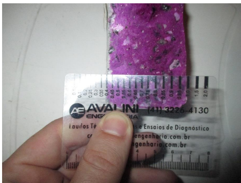
Figura 33 – Detalhamento da aferição dos Corpos de Prova sem fuligem à 90 dias
