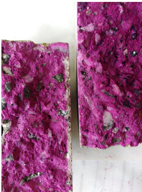
Figura 31 – Vista interna detalhada comparativa entre corpo de prova impregnado por fuligem (esquerda) e não impregnado por fuligem (direita)
