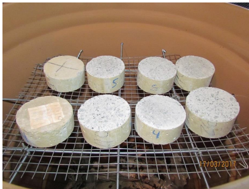
Figura 8 – Corpos de prova recortados em formato de disco de 5,00 x 10,00cm
