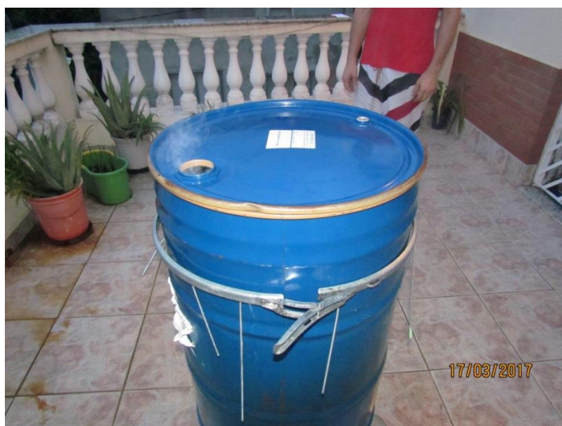
Figura 16 – Tambor tamponado para impregnação de fuligem dos corpos de prova
