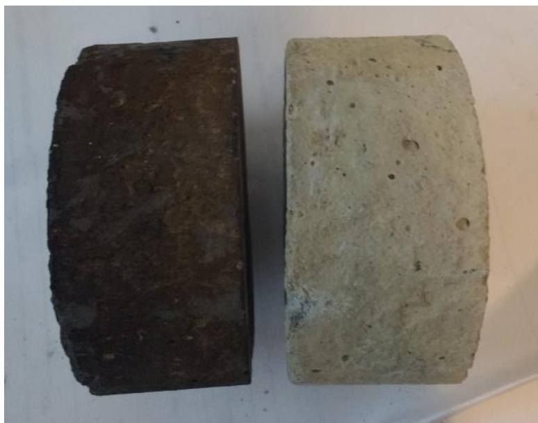
Figura 29 – Vista externa comparativa entre corpo de prova impregnado por fuligem (esquerda) e não impregnado por fuligem (direita)
