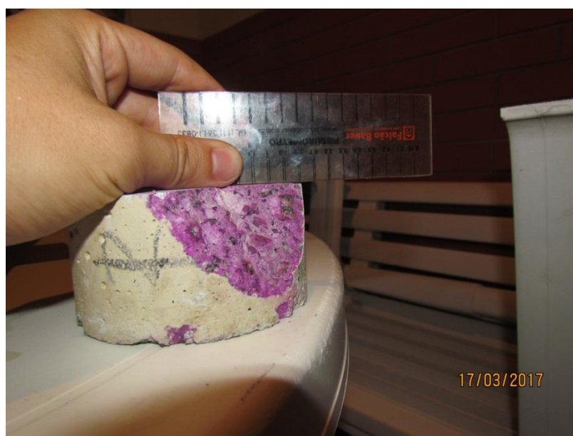
Figura 24 – Aferição da frente de carbonatação na face lateral do CP
