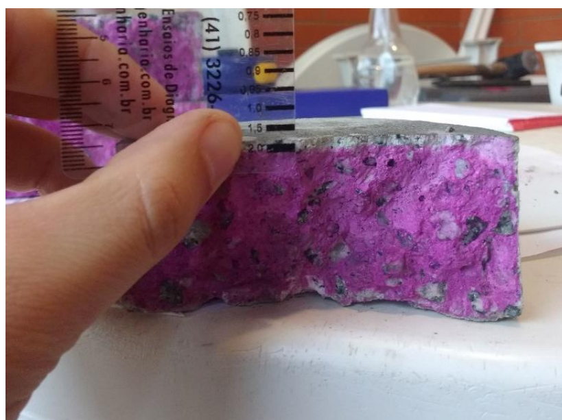
Figura 28 – Detalhamento da aferição dos Corpos de Prova impregnados por fuligem à 30 dias
