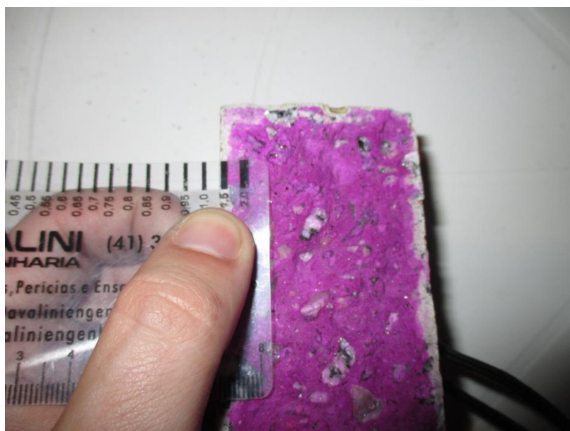
Figura 35 – Detalhamento da aferição dos Corpos de Prova impregnados por fuligem à 90 dias
