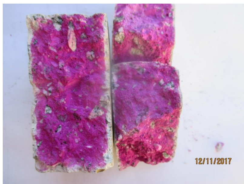
Figura 44 – Vista interna comparativa entre corpo de prova impregnado por fuligem (esquerda) e não impregnado por fuligem (direita)
