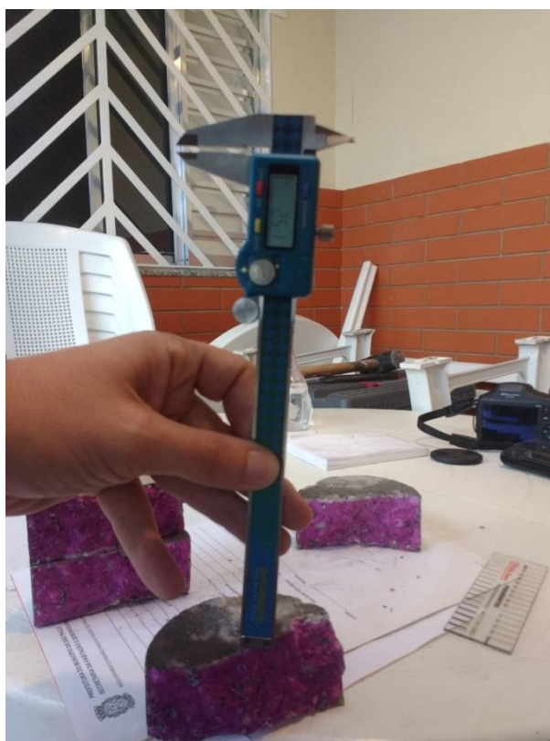
Figura 20 – Aferição da área carbonatada com paquímetro
