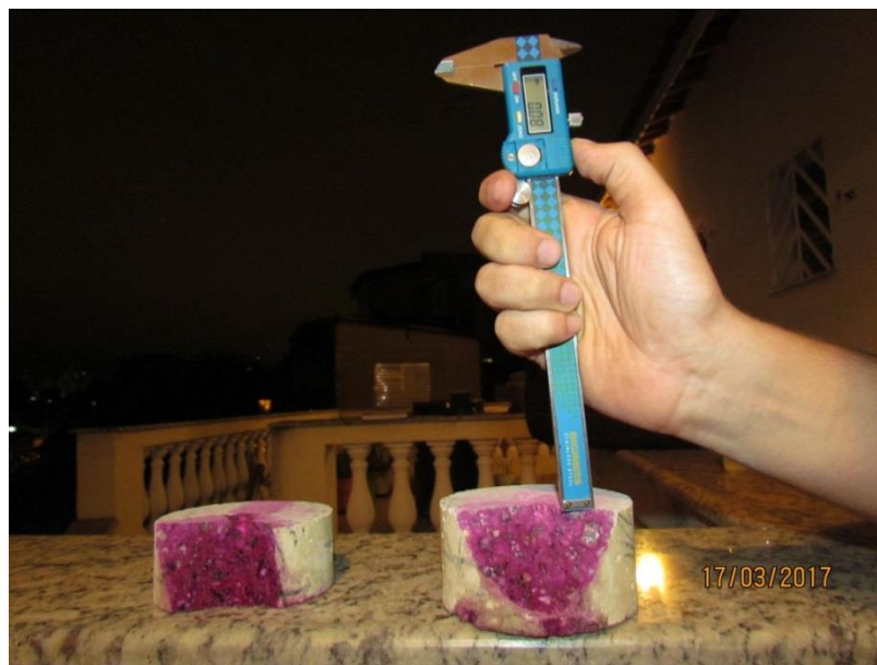
Figura 23 – Aferição da frente de carbonatação na face superior do CP
