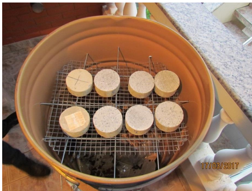
Figura 15 – Corpos de prova posicionados sobre a grelha e material combustível na parte inferior do invólucro
