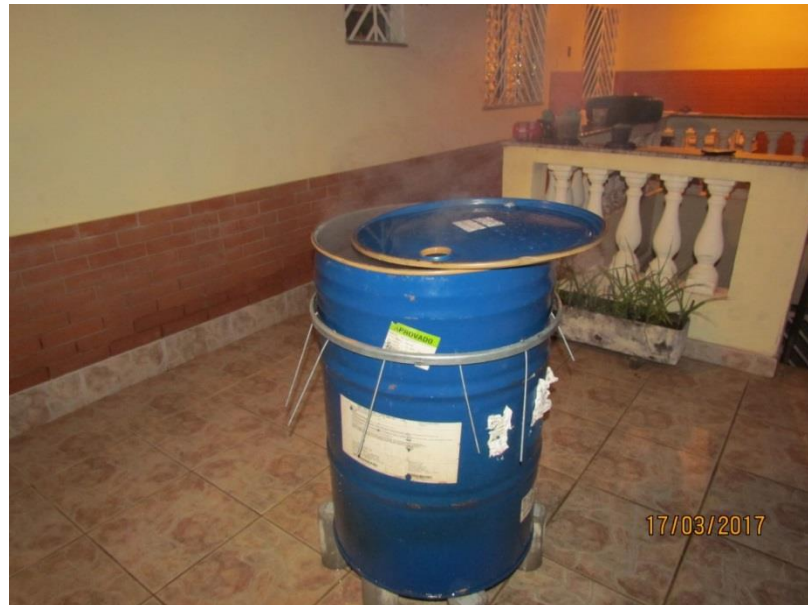
Figura 17 – Abertura da tampa para que o invólucro fosse alimentado com oxigênio
