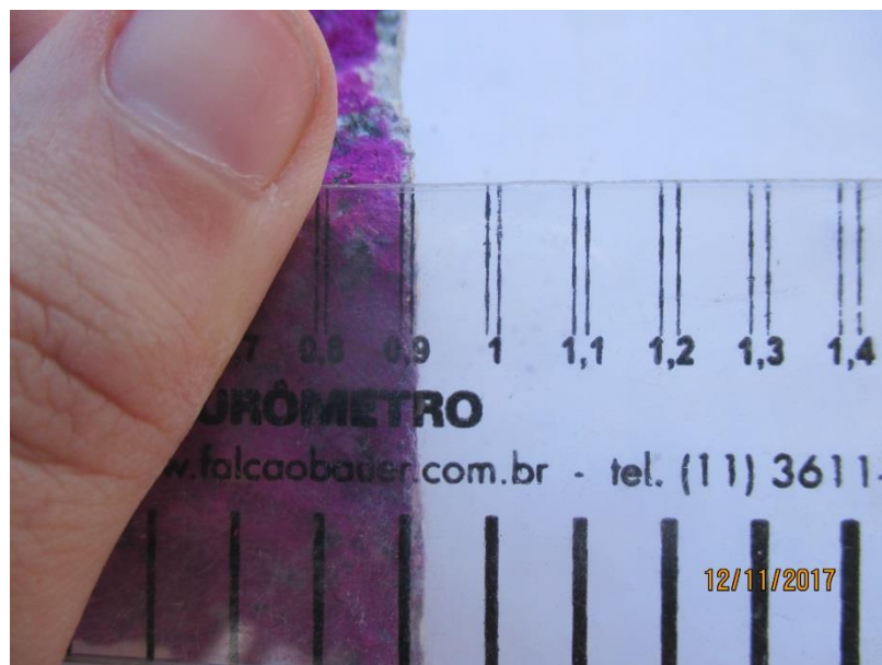
Figura 40 – Detalhamento da aferição dos Corpos de Prova sem fuligem à 180 dias
