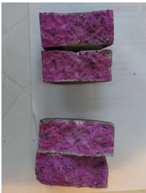
Figura 27 – Corpos de Prova impregnados fuligem à 30 dias
