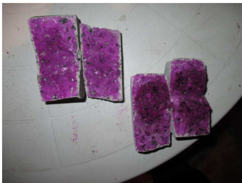
Figura 37 – Vista interna comparativa entre corpo de prova impregnado por fuligem (esquerda) e não impregnado por fuligem (direita)
