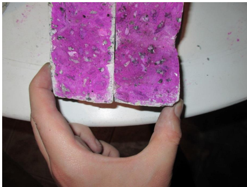
Figura 38 – Vista interna detalhada comparativa entre corpo de prova impregnado por fuligem (esquerda) e não impregnado por fuligem (direita)
