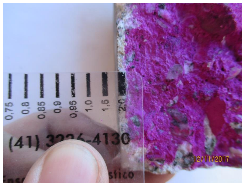
Figura 42 – Detalhamento da aferição dos Corpos de Prova impregnados por fuligem à 180 dias
