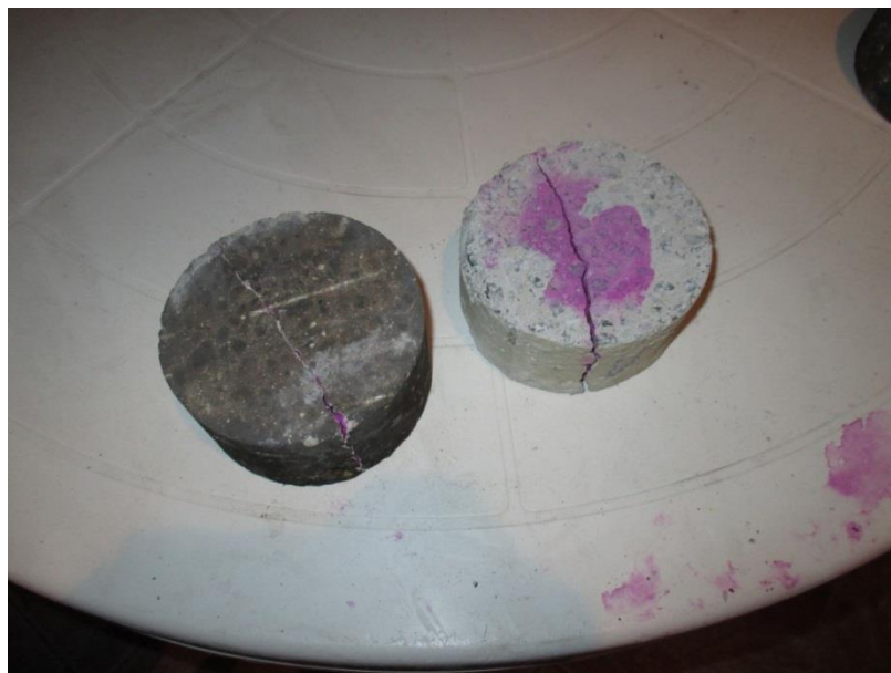
Figura 36 – Vista externa comparativa entre corpo de prova impregnado por fuligem (esquerda) e não impregnado por fuligem (direita)
