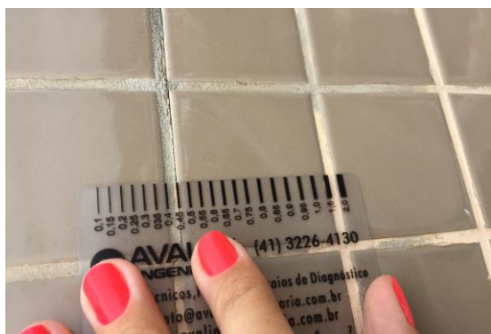
Figura 11: Inspeção Física. (A) Utilização de Fissurômetro. (B) Ensaio de percussão
