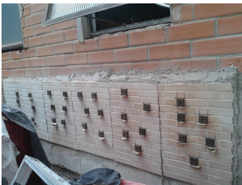
Foto 2. Fixação da base para o ensaio de arrancamento.
