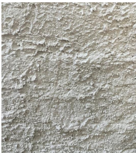
Figura 18. Teste no chapisco com uso de espátula
