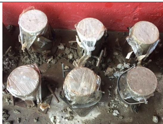
Foto 25. Detalhe dos tops dos corpos de prova para cura em tanque de imersão nas primeiras 24 horas
