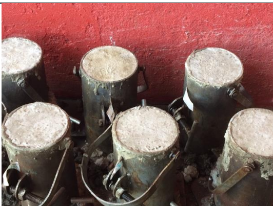
Foto 22. Detalhe dos tops dos corpos de prova curados com agente químico nas primeiras 24 horas
