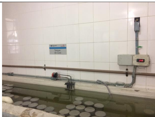
Foto 26. Corpos de prova curados em tanque de imersão
