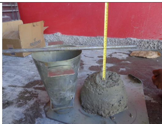
Foto 9. Abatimento concreto classe C35 – 145mm
