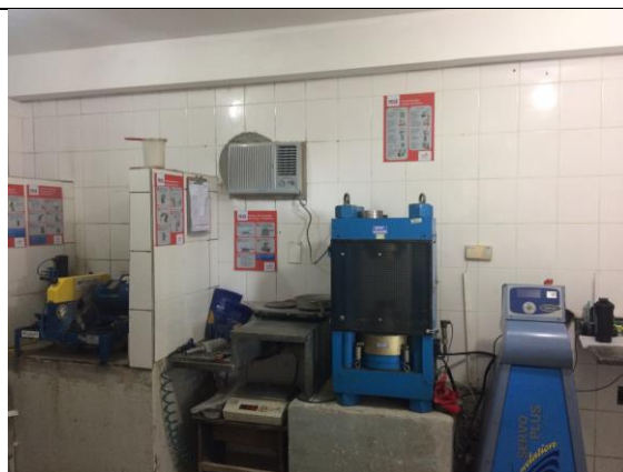
Foto 38. Retífica e Prensa Elétrica utilizadas nos ensaios
