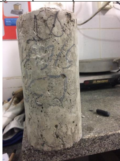
Foto 43. Corpo de prova encamisado classe C35 curado ao ar
