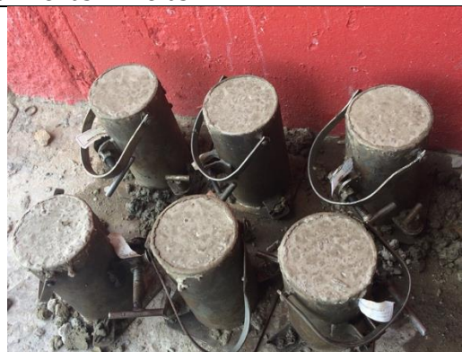
Foto 25. Detalhe dos tops dos corpos de prova para cura em tanque de imersão nas primeiras 24 horas
