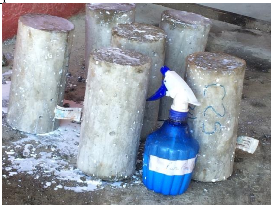
Foto 22. Detalhe dos tops dos corpos de prova curados com agente químico nas primeiras 24 horas
