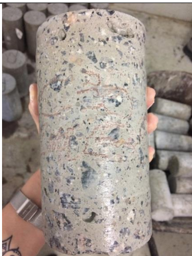
Foto 39. Testemunho classe C30 curado em água, após preparação das faces
