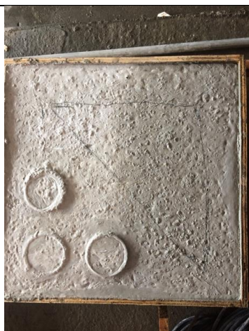
Foto 28. Marcação das caixas para extração dos testemunhos e corpos de prova encamisados
