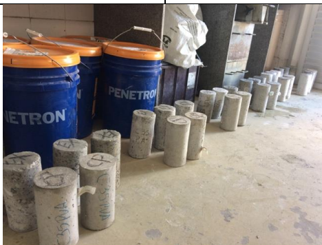
Foto 30. Detalhe das caixas após extração dos testemunhos de concreto
