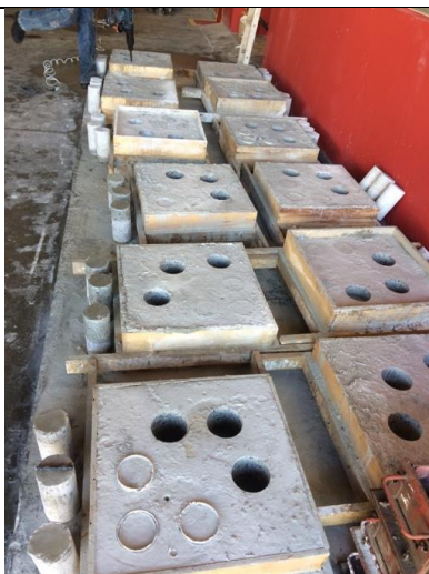
Foto 28. Marcação das caixas para extração dos testemunhos e corpos de prova encamisados
