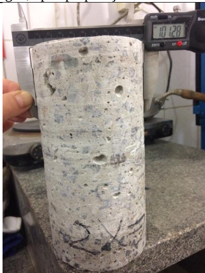
Foto 42. Testemunho classe C25 curado ao ar, após preparação das faces
