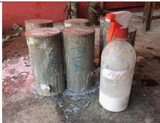
Foto 23. Detalhe dos corpos de prova curados com agente químico base PVA
