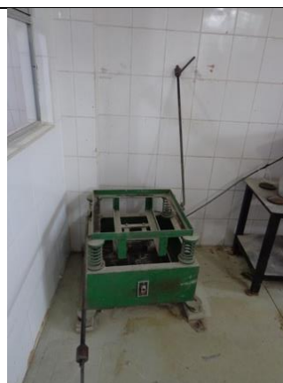
Foto 13. Agitador de peneiras utilizado para o adensamento do concreto das caixas de madeira
