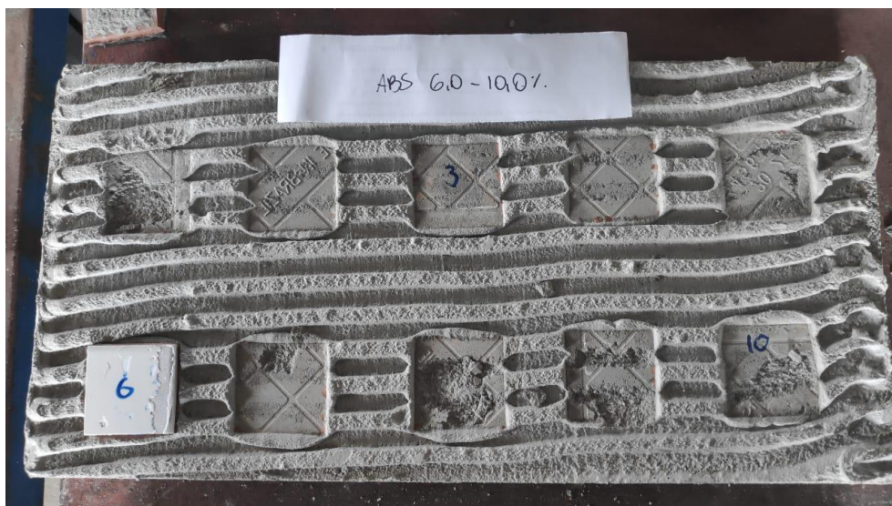
Figura 36 - Resultado do ensaio de arrancamento das peças com absorção de água entre 6,0% e 10,0%
