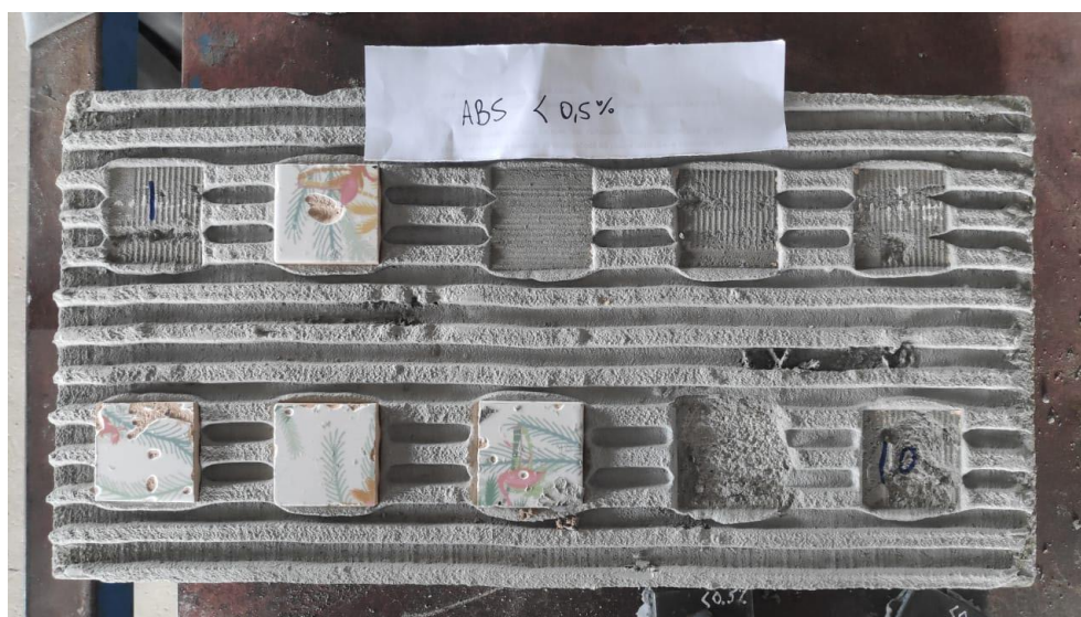
Figura 27 - Resultado do ensaio de arrancamento das peças com absorção de água menor que 0,5% Fonte: Os autores (2021).
