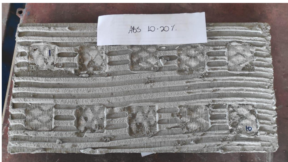
Figura 39 Resultado do arrancamento das peças com absorção de água entre 10,0% e 20,0% Fonte: Os autores (2021).
