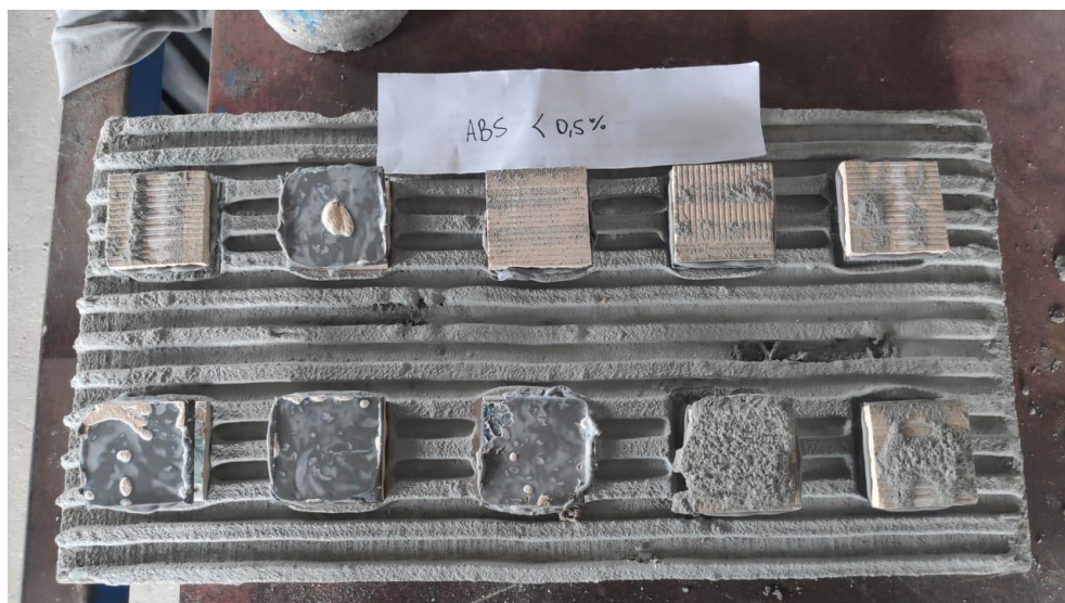
Figura 28 - Formas de ruptura das peças com absorção de água menor que 0,5% Fonte: Os autores (2021).
