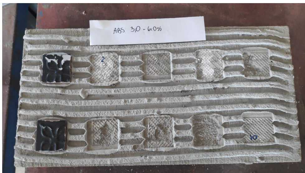
Figura 33 - Resultado do ensaio de arrancamento das peças com absorção de água entre 3,0% e 6,0% Fonte: Os autores (2021).
