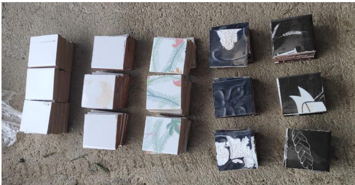
Figura 16 - Amostras de revestimentos fatiadas para execução dos ensaios
