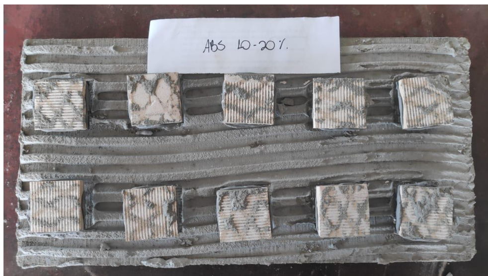
Figura 40 - Formas de ruptura das peças com absorção de água entre 10,0% e 20,0%
