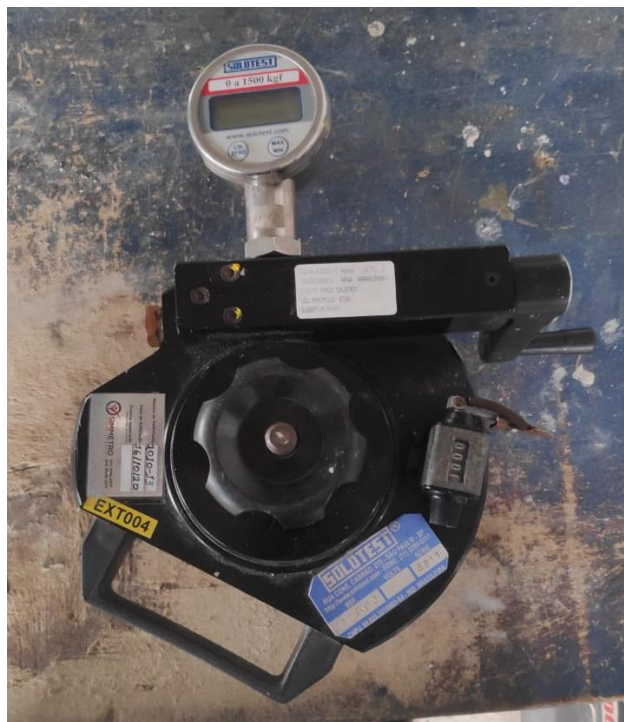
Figura 24 – Adérímetro utilizado no ensaio de arrancamento
