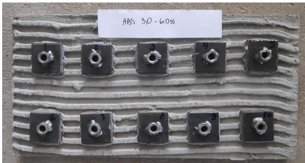
Figura 32 - Disposição das peças com absorção de água entre 3,0% e 6,0% Fonte: Os autores (2021).
