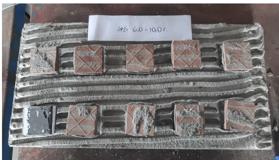
Figura 37 - Formas de ruptura das peças com absorção de água entre 6,0% e 10,0%
