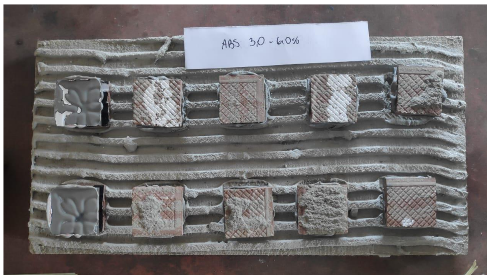
Figura 34 - Formas de ruptura das peças com absorção de água entre 3,0% e 6,0% Fonte: Os autores (2021).
