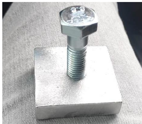
Figura 3 - Pastilha utilizada no ensaio de arrancamento Fonte: Os autores (2021).
