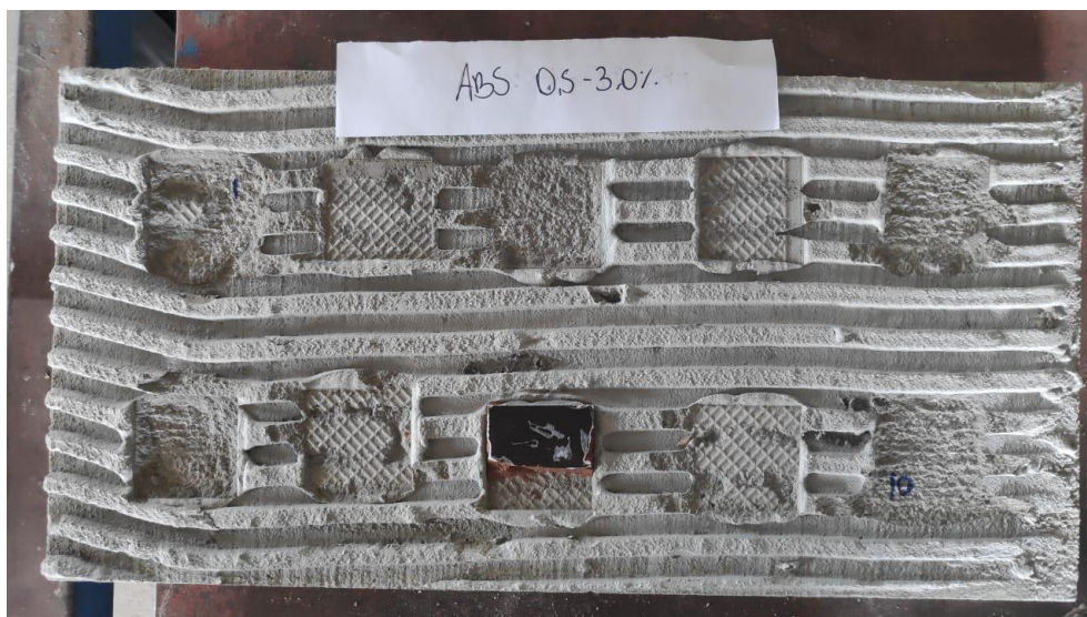
Figura 30 - Resultado do ensaio de arrancamento das peças com absorção de água entre 0,5% e 3,0%
