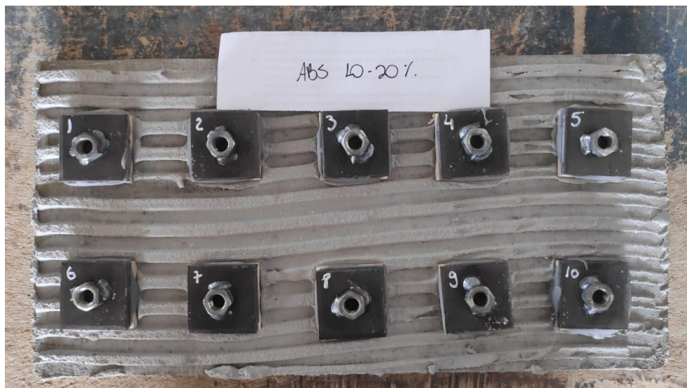
Figura 38 - Disposição das peças com absorção de água entre 10,0% e 20,0% Fonte: Os autores (2021).
