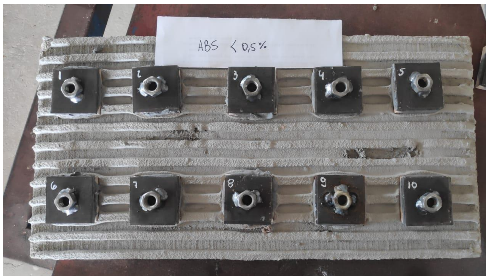
Figura 26 - Disposição das peças com absorção de água menor que 0,5% Fonte: Os autores (2021).
