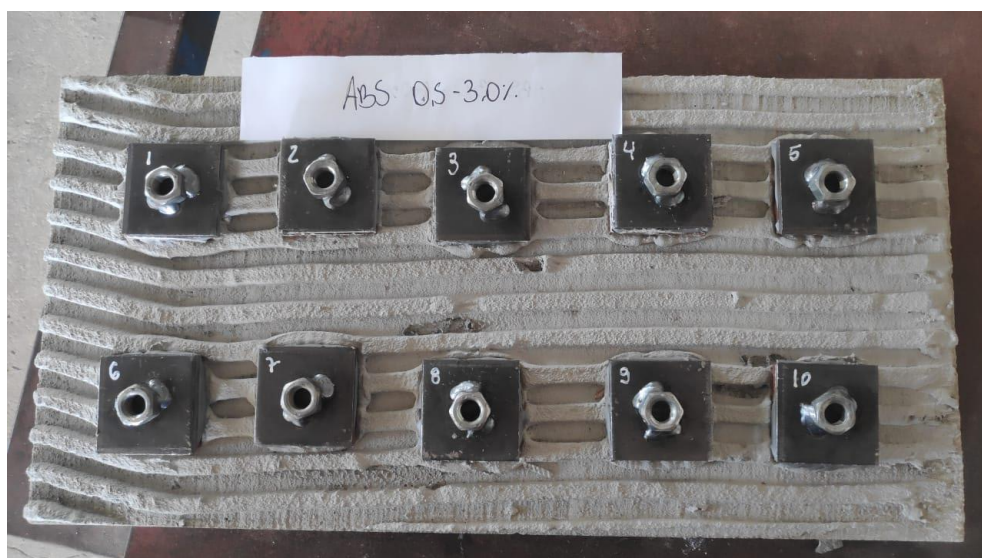
Figura 29 - Disposição das peças com absorção de água entre 0,5% e 3,0% Fonte: Os autores (2021).
