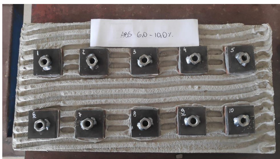
Figura 35 - Disposição das peças com absorção de água entre 6,0% e 10,0% Fonte: Os autores (2021).
